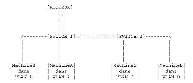
Dans l'exemple précédent, chaque switch définit 2 VLANs. Pour le premier switch, les VLAN A et B. Pour le second switch, les VLAN C et D.
