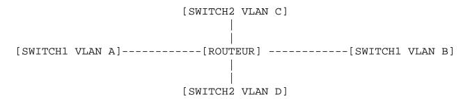
Pour qu'un PC du VLAN A communique avec un PC du VLAN, son paquet passe par le premier switch, utilise le trunk entre le switch et le routeur. Il arrive ensuite au routeur qui le renvoie vers le switch (toujours par le trunk) en le mettant sur le VLAN B. Arrivé au switch, le paquet passe sur le segment où se trouve le PC destinataire.
